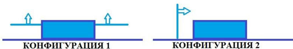
Рисунок 8 – Схема прохождения ударной волной препятствия в двух конфигурациях: конфигурация 1 – дифракция от плазменного листа на обратном уступе; конфигурация 2 – дифракция на задней стенке.
